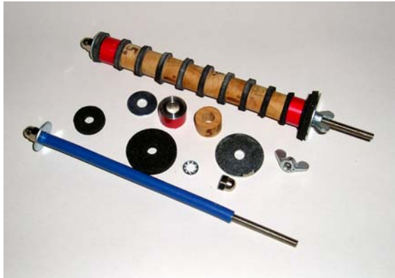
Figur 17. OE-metoden för att gravimetriskt mäta RF i ett borrar hål.
